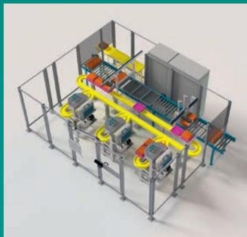
전자동화된 고객별 배터리 셀 EOL 누설 테스트.
